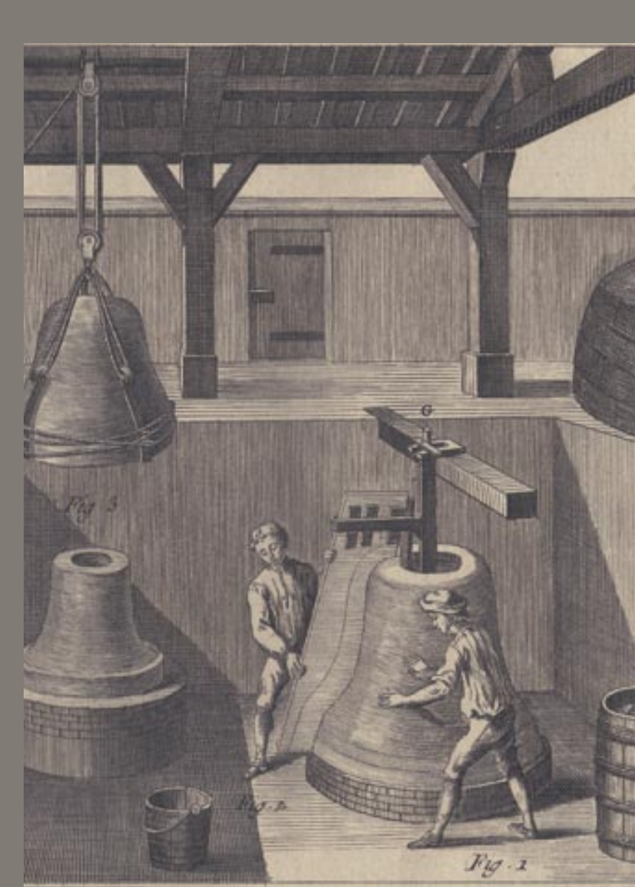
Encyclopédie Diderot, 1786. Fonte des cloches. Fabrication du moule.
