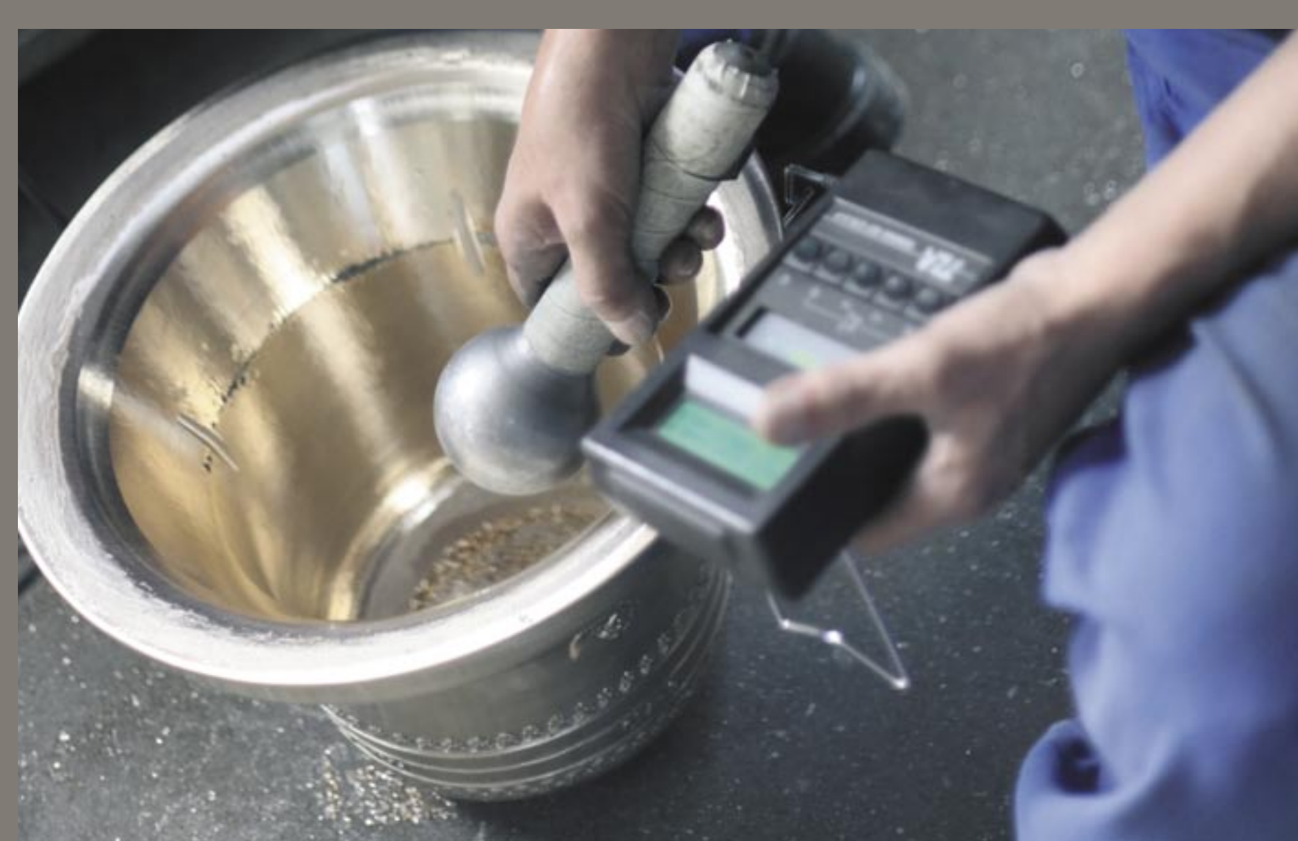
Ateliers PACCARD - accordage d'une cloche Photo Yannick Perrin©Fonderie PACCARD
