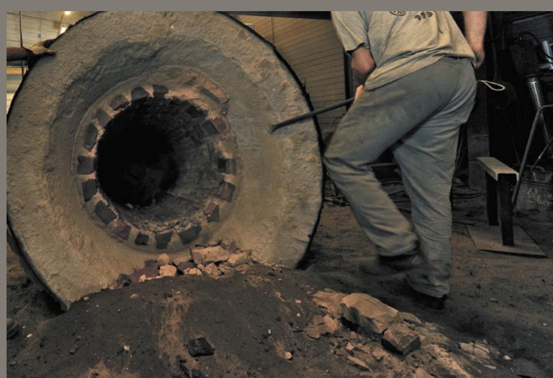
Ateliers PACCARD - déburrage d'une cloche Photo Zeppzlin©Fonderie PACCARD
