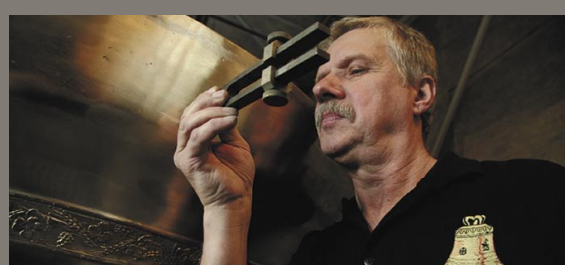
Ateliers PACCARD - accordage d'une cloche Photo Zeppellini©Fonderie PACCARD
