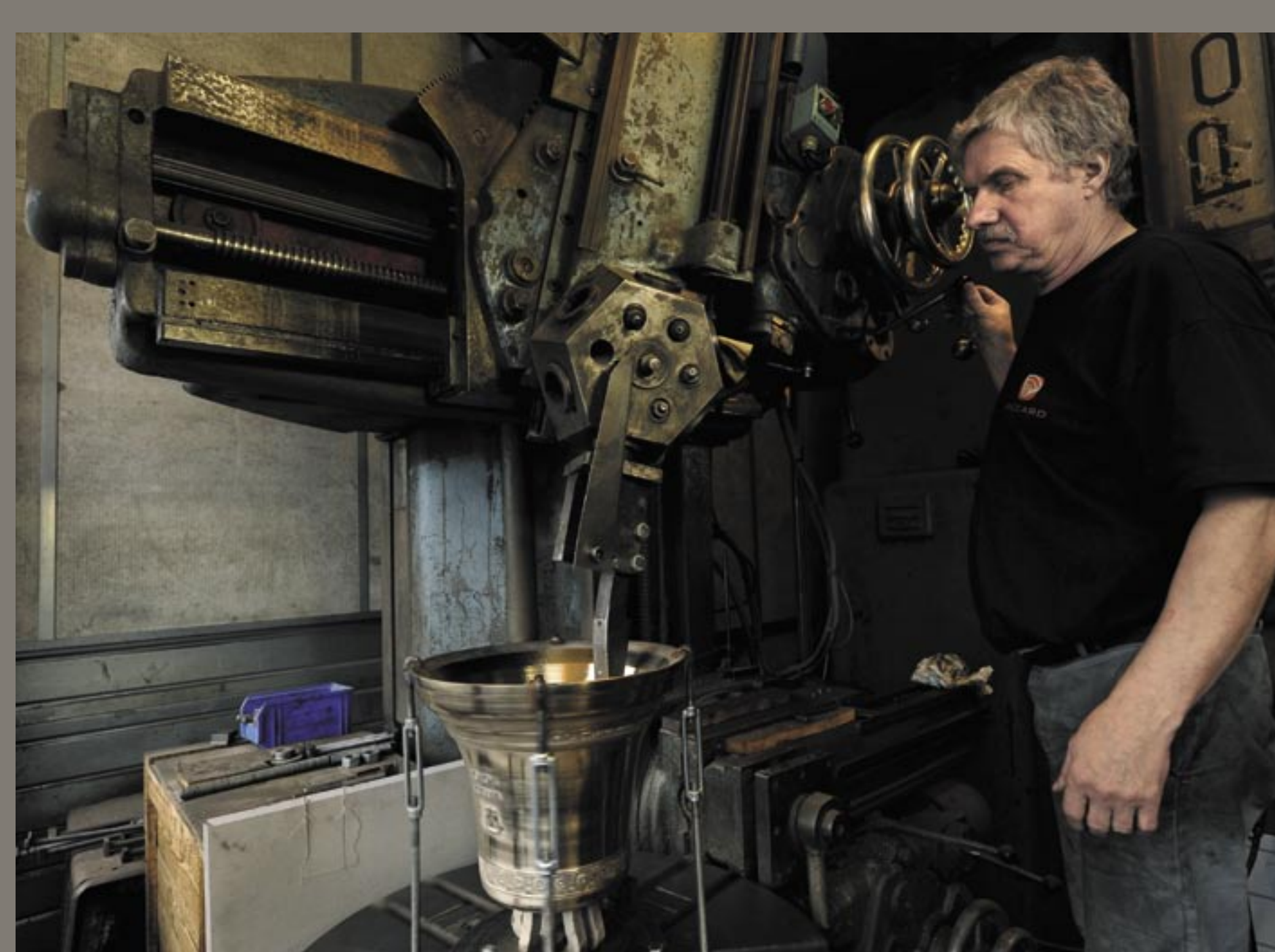
Ateliers PACCARD - accordage d'une cloche Photo Zeppellini©Fonderie PACCARD
